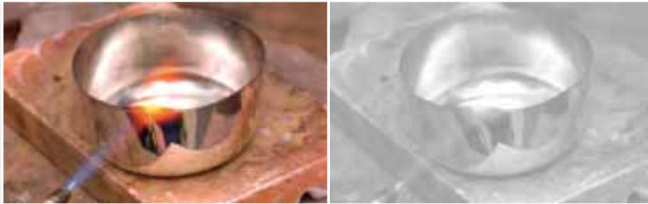
**CREUSETS POUR MACHINES DE FUSION CLAISSE-FLUXER en platine/or 95/5 ou platine/or 95/5 FKS**
